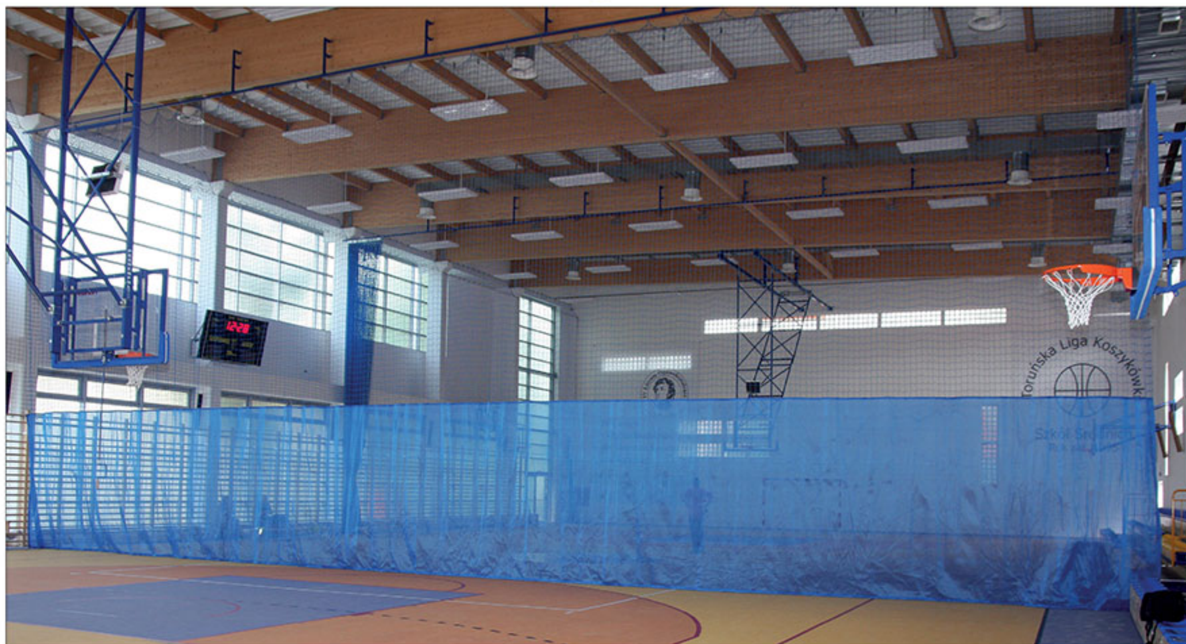
Posuvný systém deliacich závesov s manuálnym pohonom
