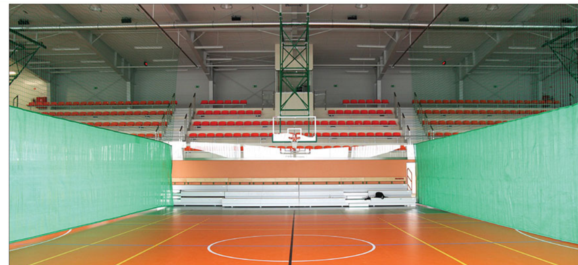
Posuvný systém deliacich závesov s elektrickým pohonom
